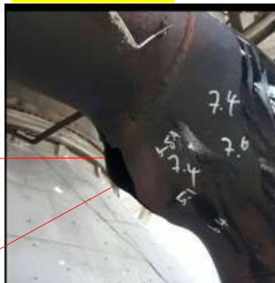
Pic. ปล่อย DSH ชั้น 8 AQC Boiler ที่ท่อแตกกระเปิด
